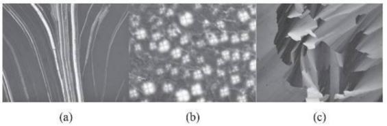
(a) ラメラ液晶 (oily streaks), (b) ラメラ液晶 (maltose cross), (c) ヘキサゴナル液晶の偏光顕微鏡観察像
